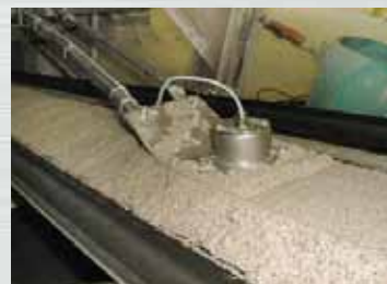
FSV mit Sondenschlitten auf Förderband
