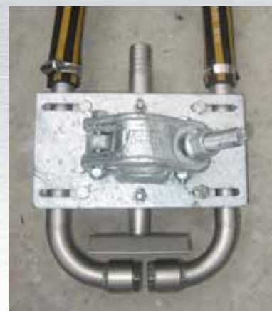
OLAS Messkopf wird mittels Standard-Gerüstschelle am Halterungsrohr befestigt
