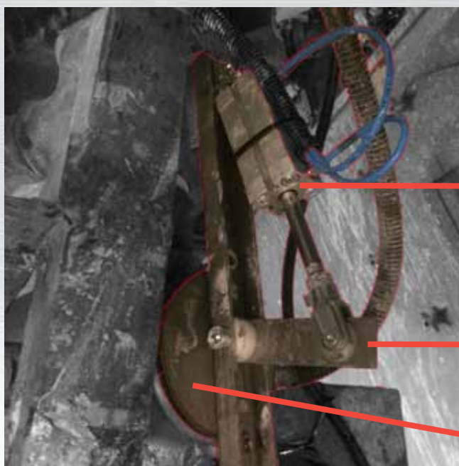
Abb.: 2,5" Messkopf-Ausführung mit spez. Verschluss und Druckluft-Mechanik
