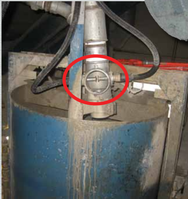
Abb.: 2,5" Restwasser-Leitung - Einfache Messkopf-Ausführung mit schraubbarem Verschluss
