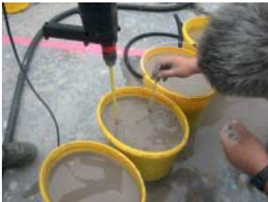
Fig. 6 Density determination of samples by means of an areometer. Abb. 6 Ermittlung der Dichte von Proben mittels Aräometer.
