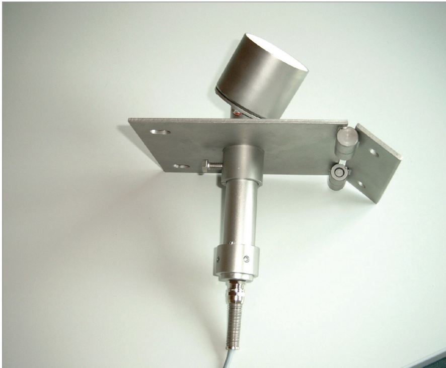
Sonde mit Knickarm für flexible Einstellung vor Ort
